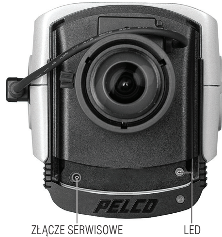
WIDOK PRZEDNI, JEDYŃIE KAMERA (OTWARTE DLA UKAZANIA ZŁĄCZA SERWISOWEGO)
